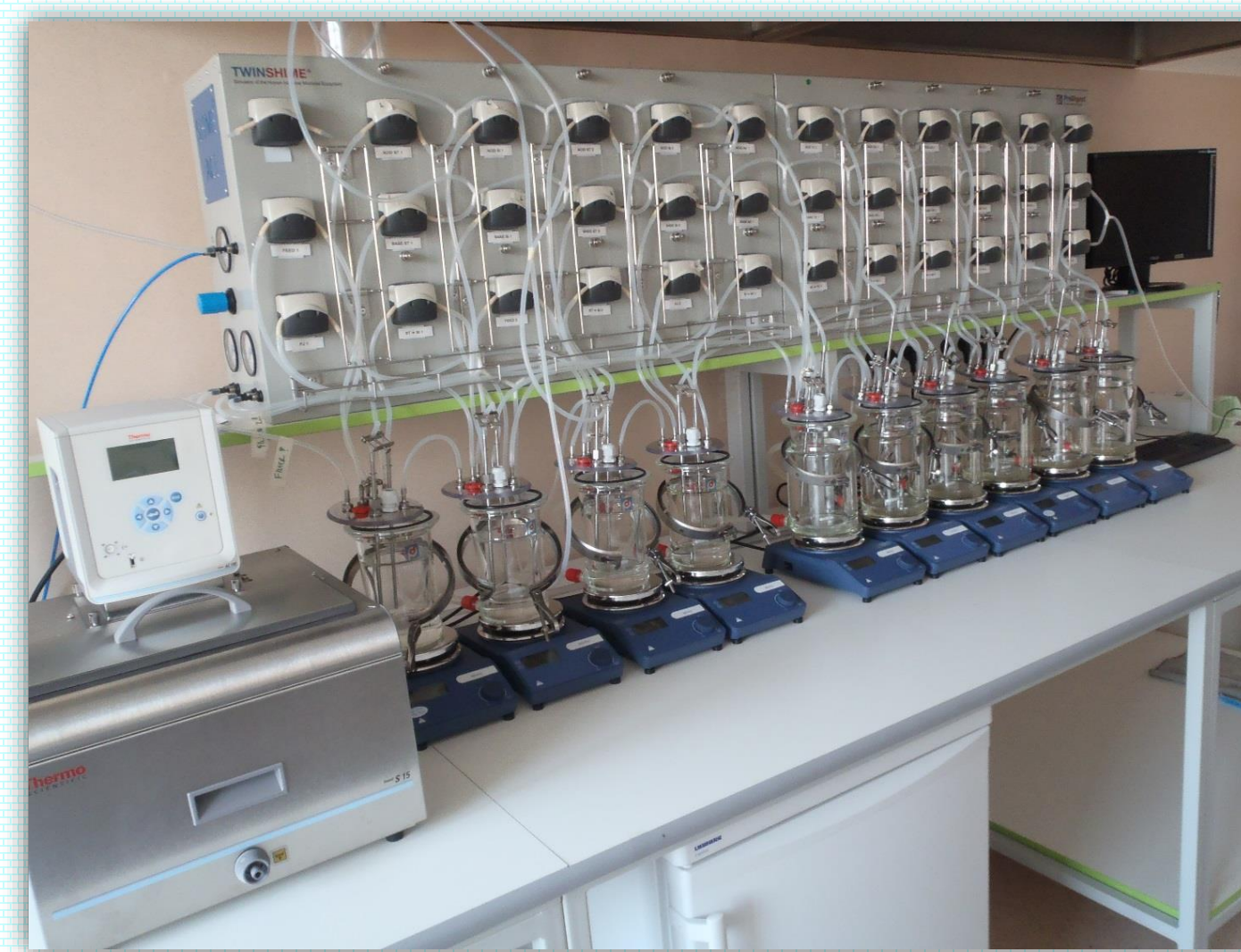
Model gastrointestinálneho traktu človeka – SHIME®
